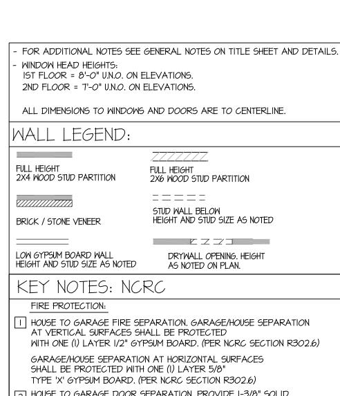
HOUSE TO GARAGE FIRE SEPARATION. GARAGE/HOUSE SEPARATION WITH ONE (I) LAYER I/2" GYPSUM BOARD. (PER NCRC SECTION R302.6)
