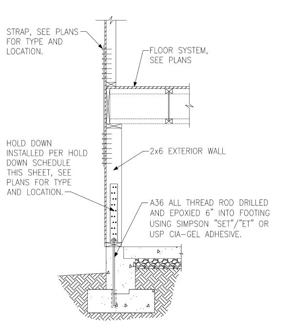
HOLD DOWN AT STEM WALL SLAB FOUNDATION
