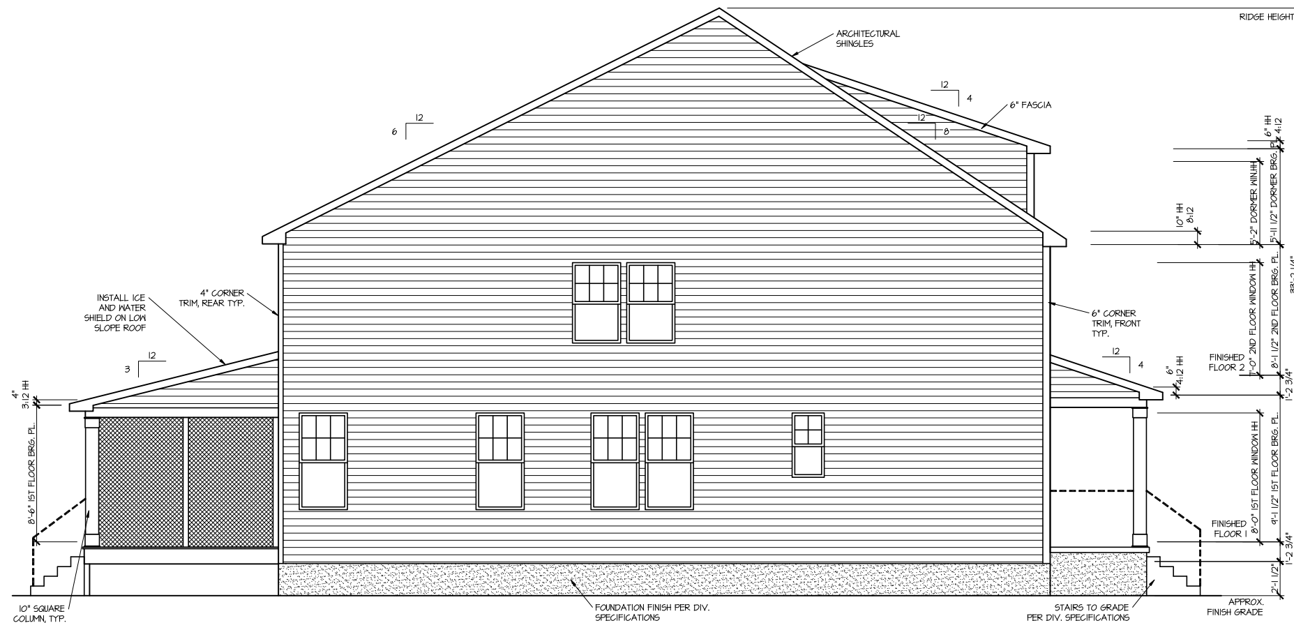
LEFT ELEVATION 2 SCALE: 1/8" = 1'-0"
