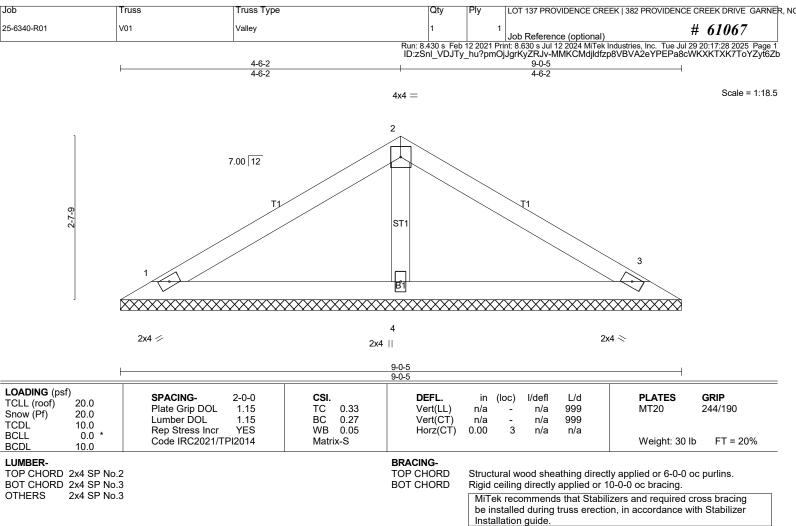
REACTIONS. (lb/size) 1=150/9-0-5 (min. 0-1-8), 3=150/9-0-5 (min. 0-1-8), 4=335/9-0-5 (min. 0-1-8) Max Horz 1=-51(LC 12)
