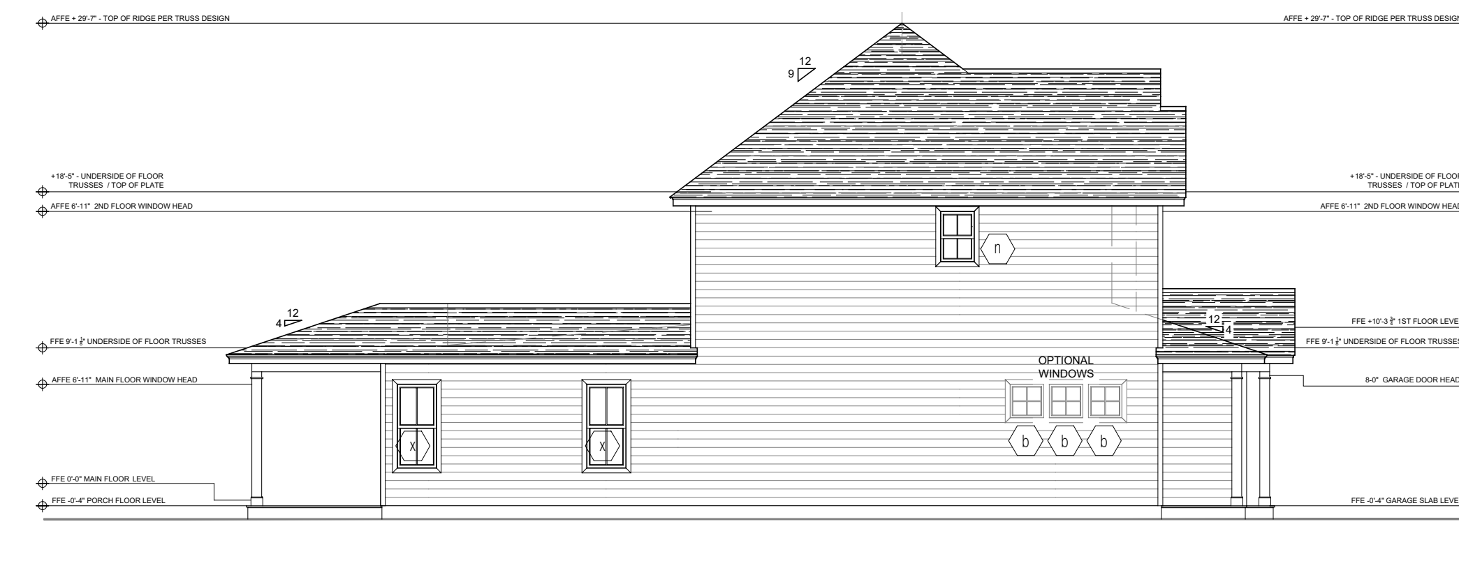
LEFT SIDE ELEVATION - OPTION "B" SCALE: 1/8" = 1'-0"
