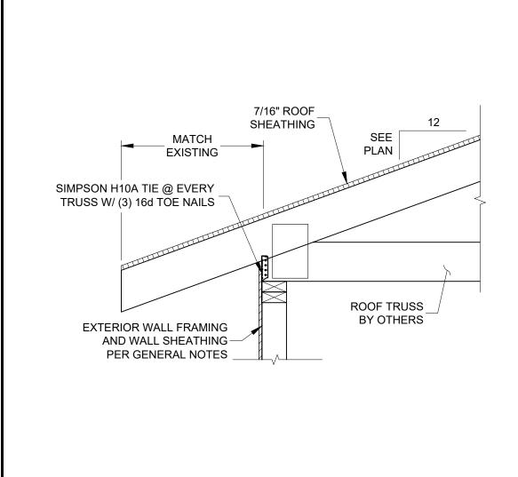
TYP. TRUSS AT PERIMETER WALL
