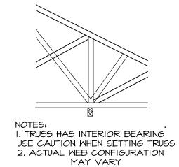
INTERIOR TRUSS BEARING DETAIL SCALE: NTS
