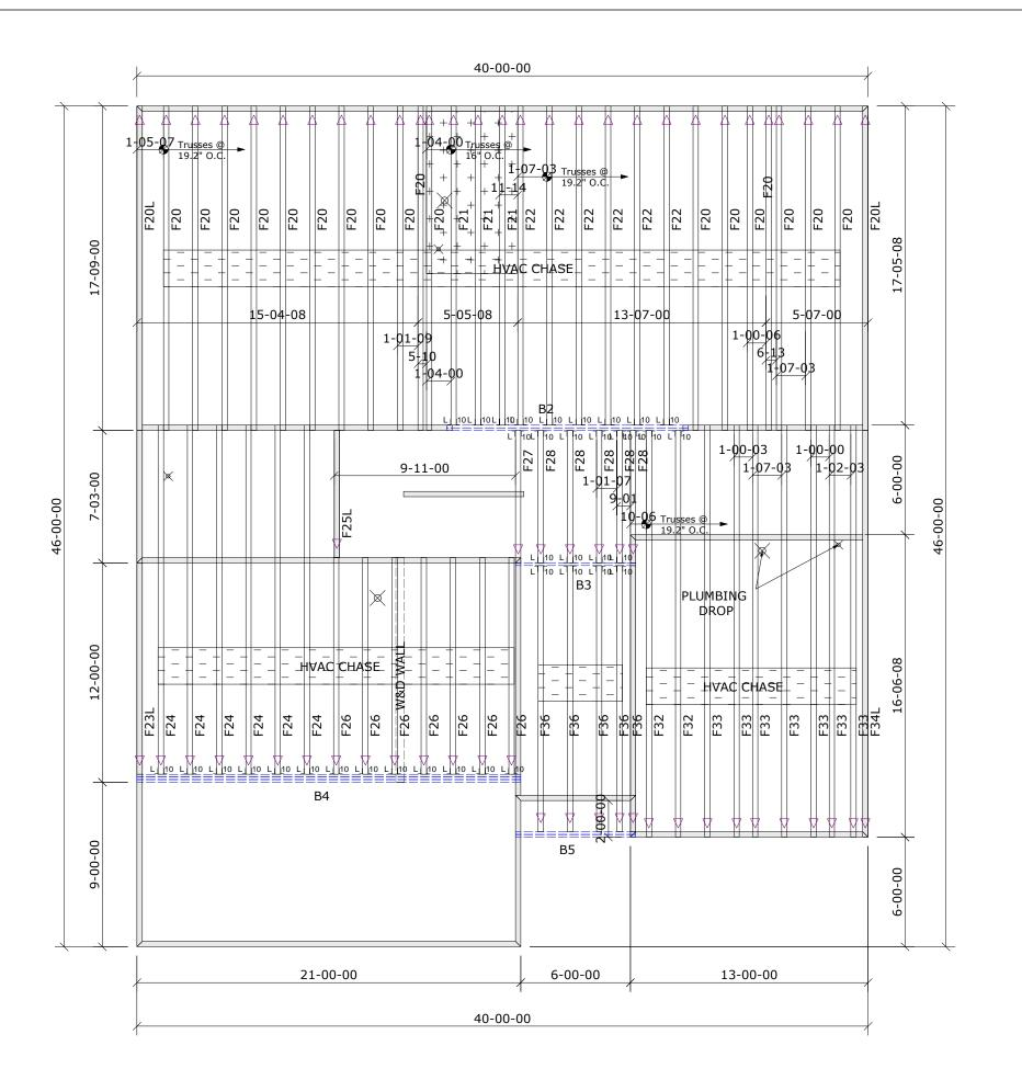
NOTE: LEFT END OF TRUSS AS SHOWN ON TRUSS DETAIL DRAWINGS ARE INDICATED BY TRIANGLE ICONS.  $\triangle$
