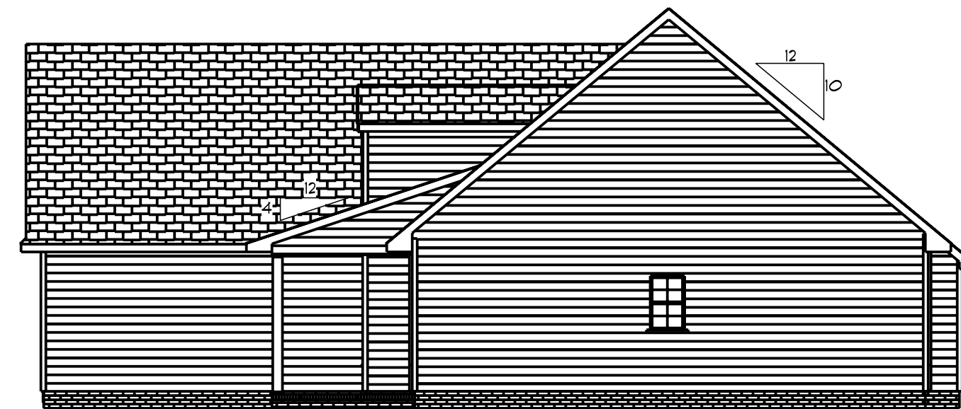
Right Elevation Scale: 1/8" = 1'0"
