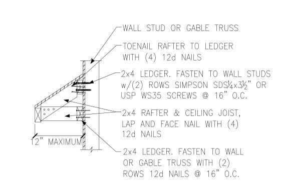
EYEBROW ROOF DETAIL STRAIGHT ROOF
