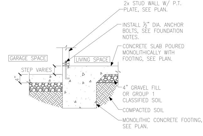
FOUNDATION SECTION INTERIOR GARAGE WALL
