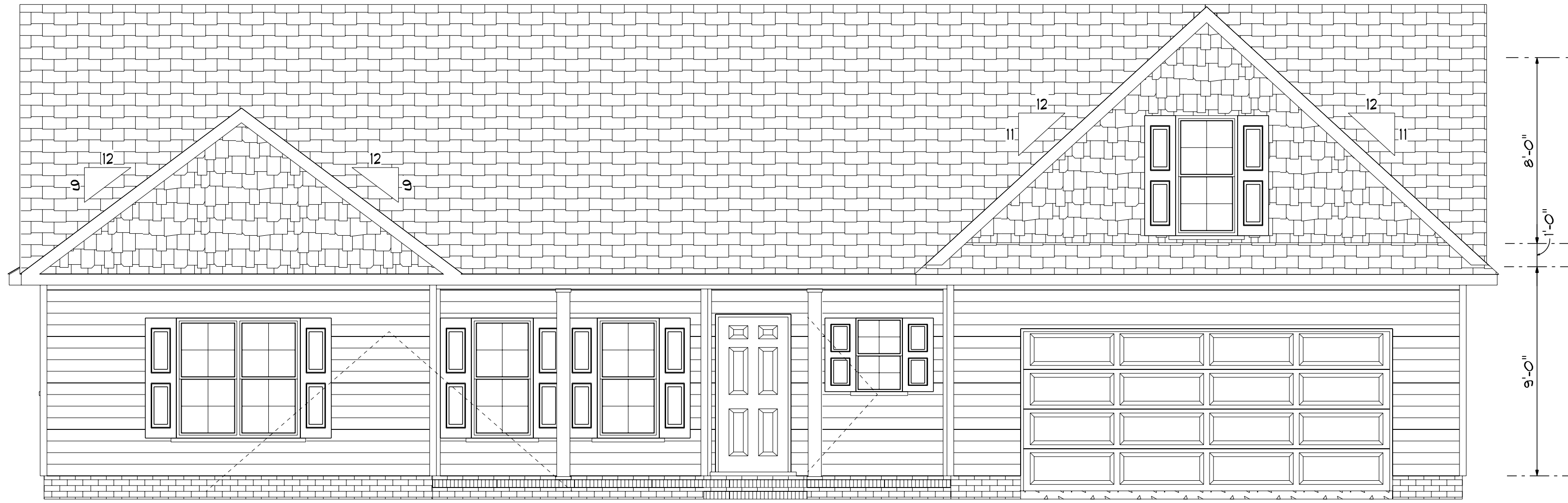
Front Elevation Scale: 1/4" = 1'0"
