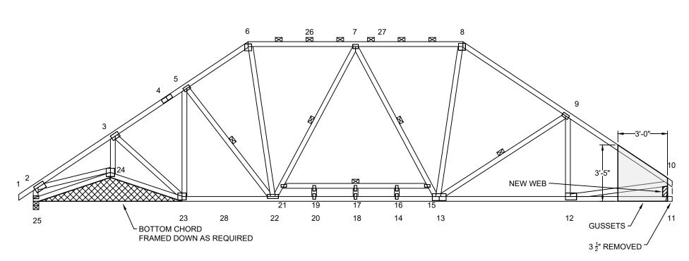
THE VAULTED BOTTOM CHORDS OF THIS A02X TRUSS ARE BUILT INTO THE TRUSS SHOULD BE FLAT. THE RIGHT END OF THE TRUSS NEEDS TO BE STUBBED BACK BY 3 1/2".
