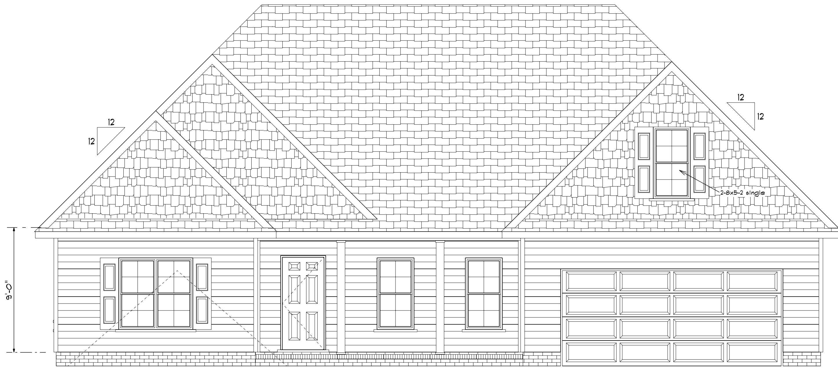
Front Elevation Scale: 1/4" = 1'0"
