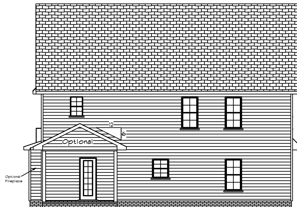
Rear Elevation Scale: 1/8" = 1'0"
