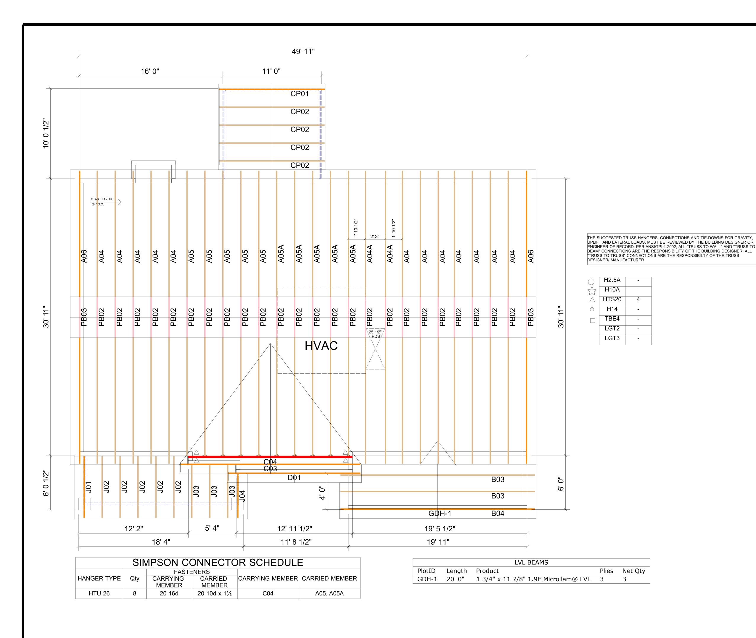
DO NOT CUT, DRILL, NOTCH, OR OTHERWISE DAMAGE TRUSSES. Contact your BFS Representative for assistance PRIOR TO modifying any truss. *Espanol* - (NO CORTE, PERFORE, HAGA MUESCAS O DANE DE CUALQUIER OTRA MANERA LAS TRUSSES (CERCHAS DE MADERA). Contacte a su representante de BFS para asistencia ANTES de realizar cualquier modification.)
