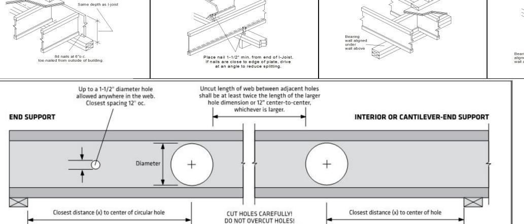
JOIST SUPPORT NAILING
