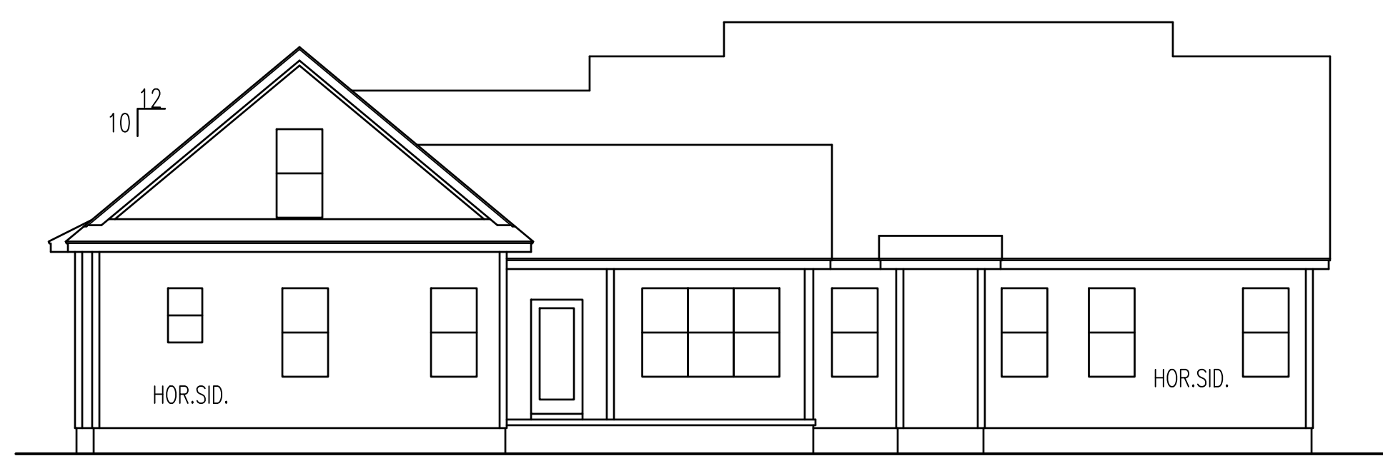
REAR ELEVATION SCALE: 1/8" = 1'-0"
