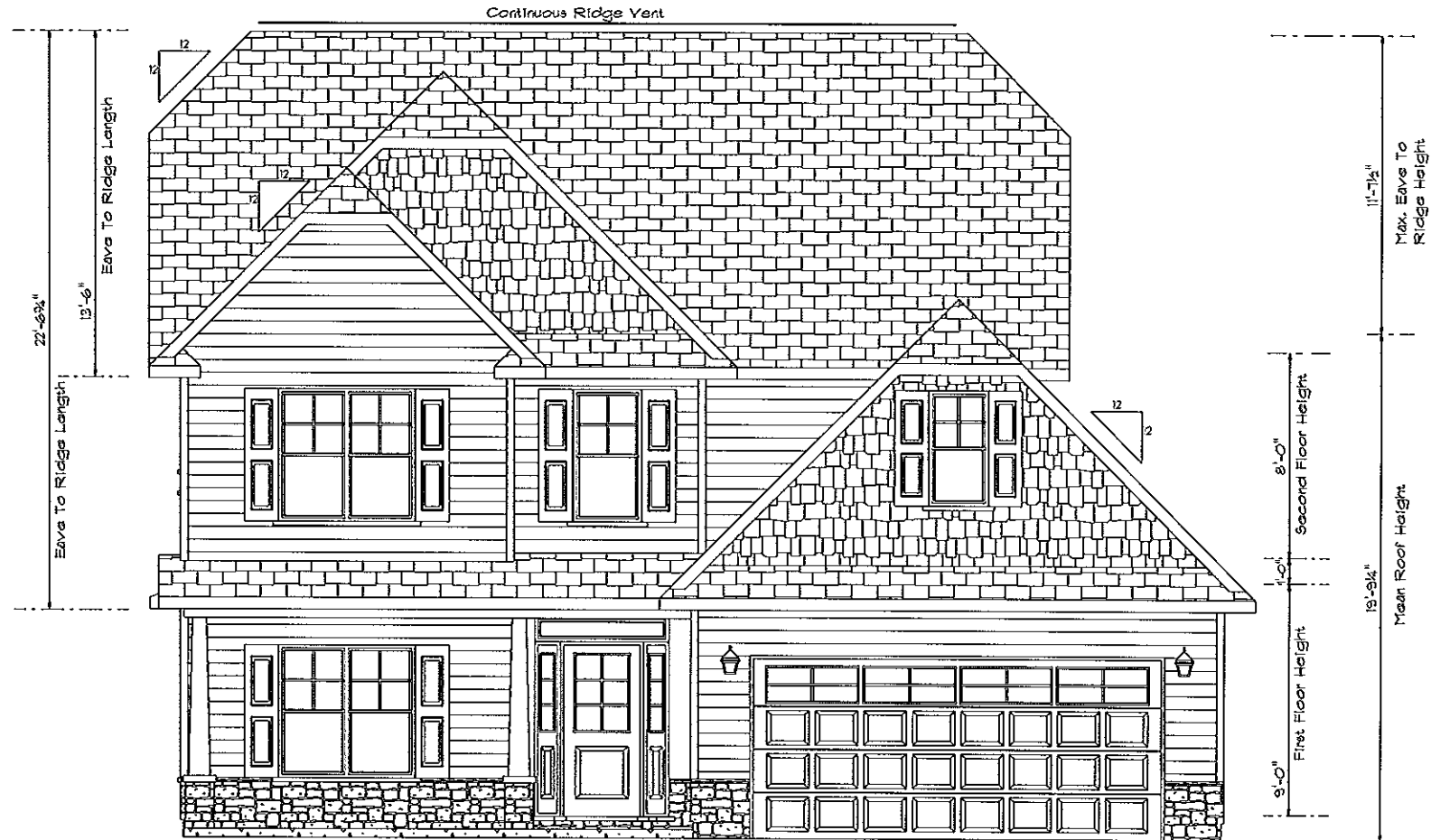
Front Elevation Scale: 1/4" = 1'0"
