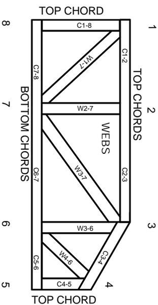
**JOINTS ARE GENERALLY NUMBERED/LETTERED CLOCKWISE AROUND THE TRUSS STARTING AT THE JOINT FARTHEST TO THE LEFT.**
