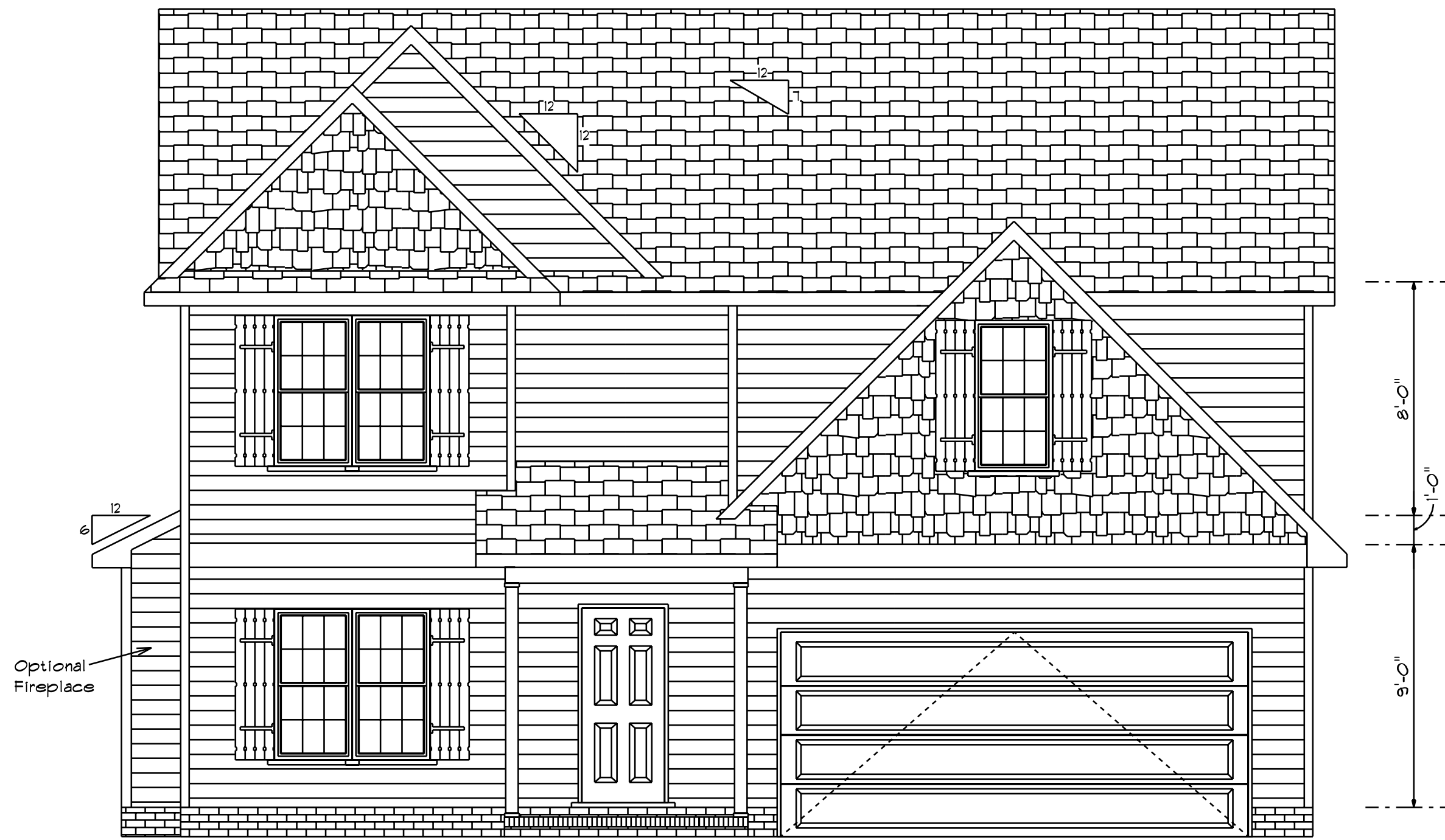
Front Elevation Scale: 1/4" = 1'0"
