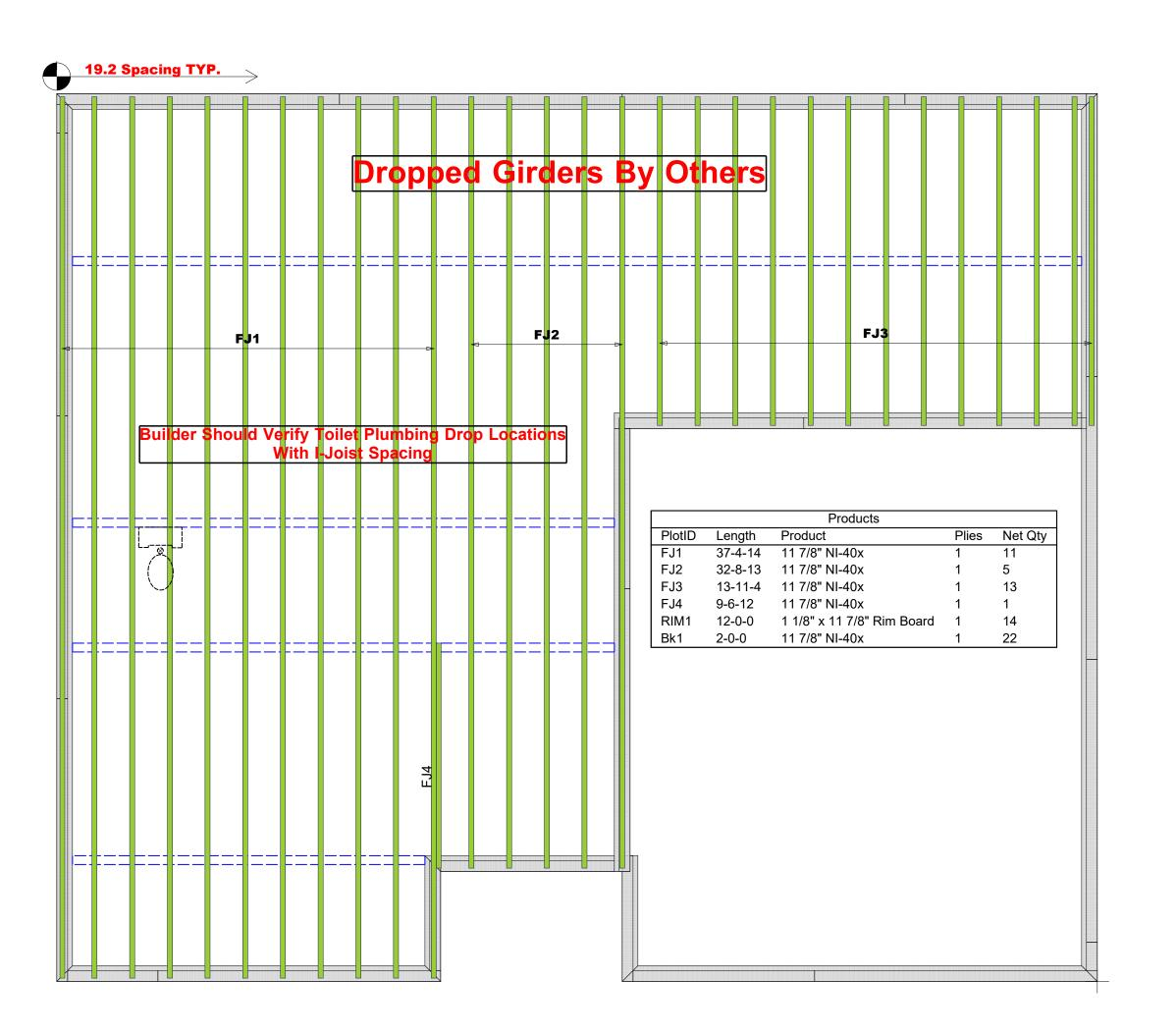
соттесн **ROOF & FLOOR TRUSSES & BEAMS**
