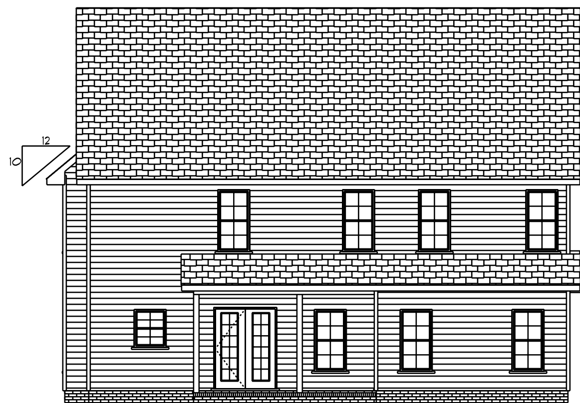
Rear Elevation Scale: 1/8" = 1'0"
