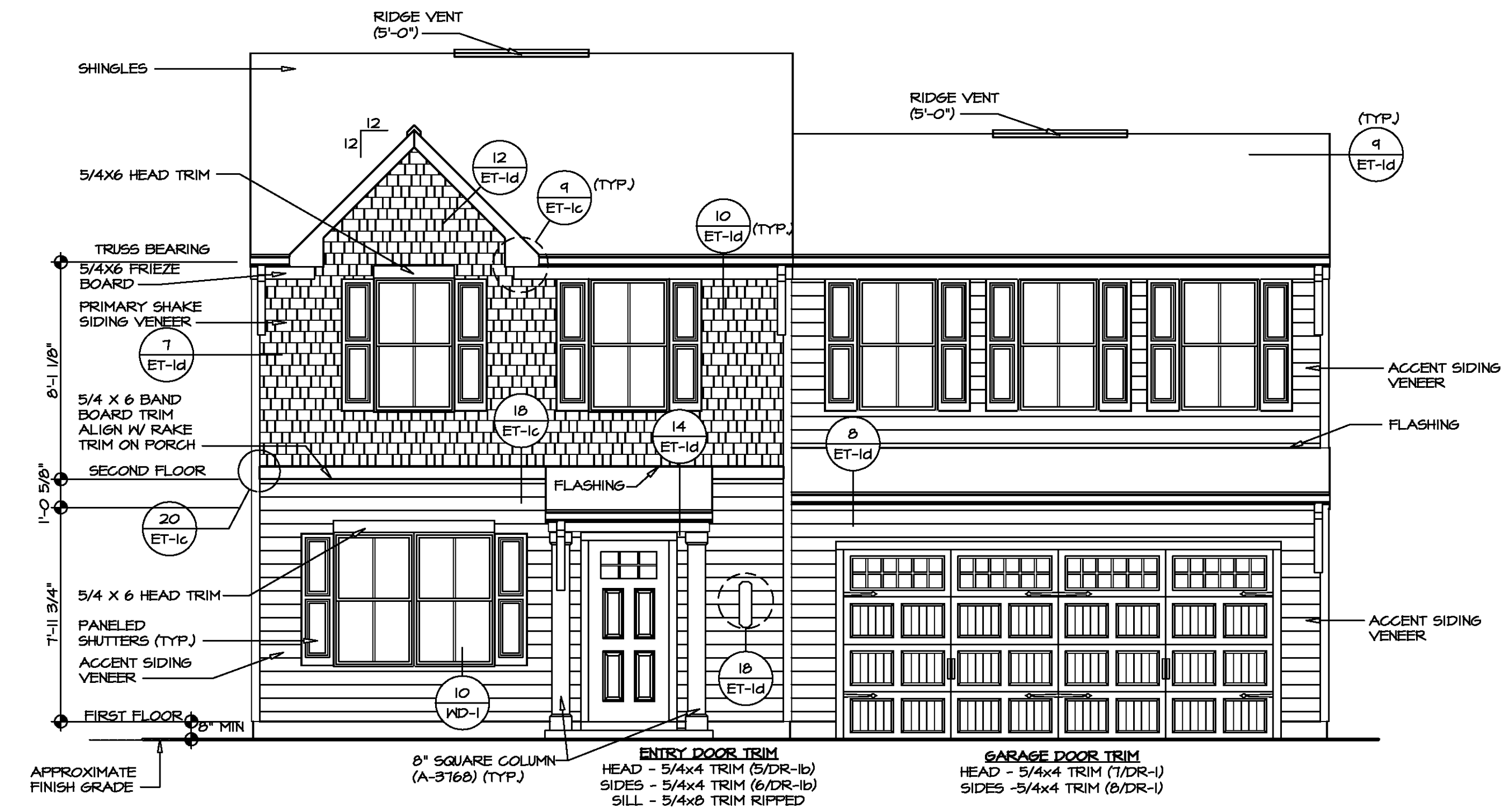
1 FRONT ELEVATION "K" A-1 SCALE: 1/4" = 1'-0"
