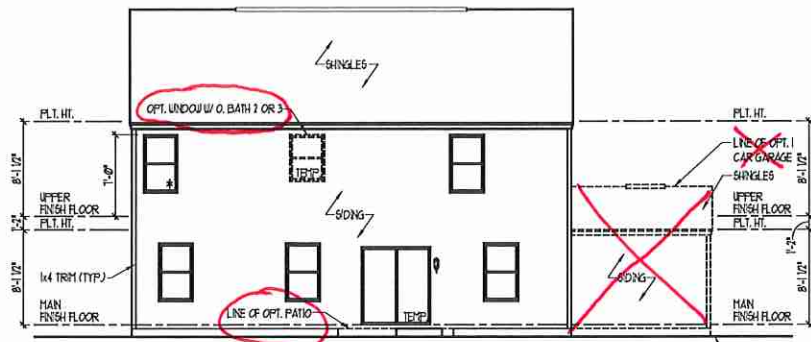
REAR ELEVATION SCALE: 1/8" = 1'-0"
