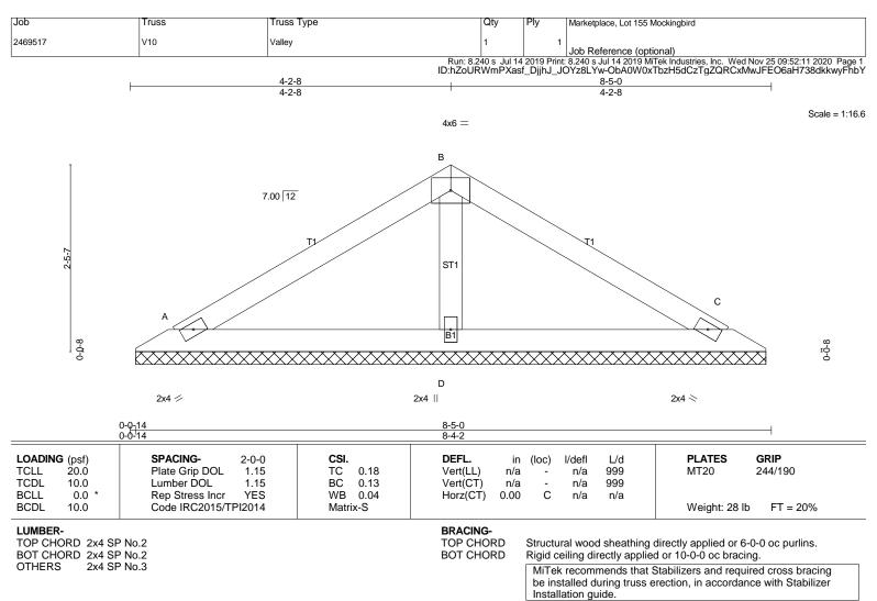
**REACTIONS.** (lb/size) A=138/8-3-5 (min. 0-1-8), C=138/8-3-5 (min. 0-1-8), D=305/8-3-5 (min. 0-1-8)
