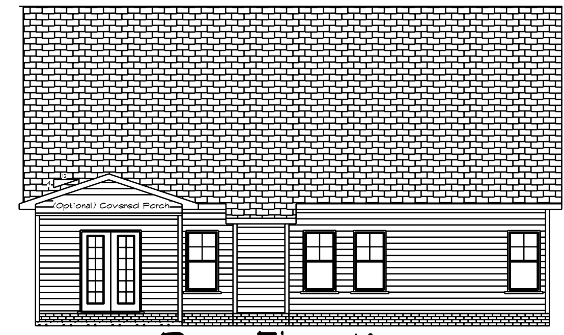
Rear Elevation Scale: 1/8" = 1'0"
