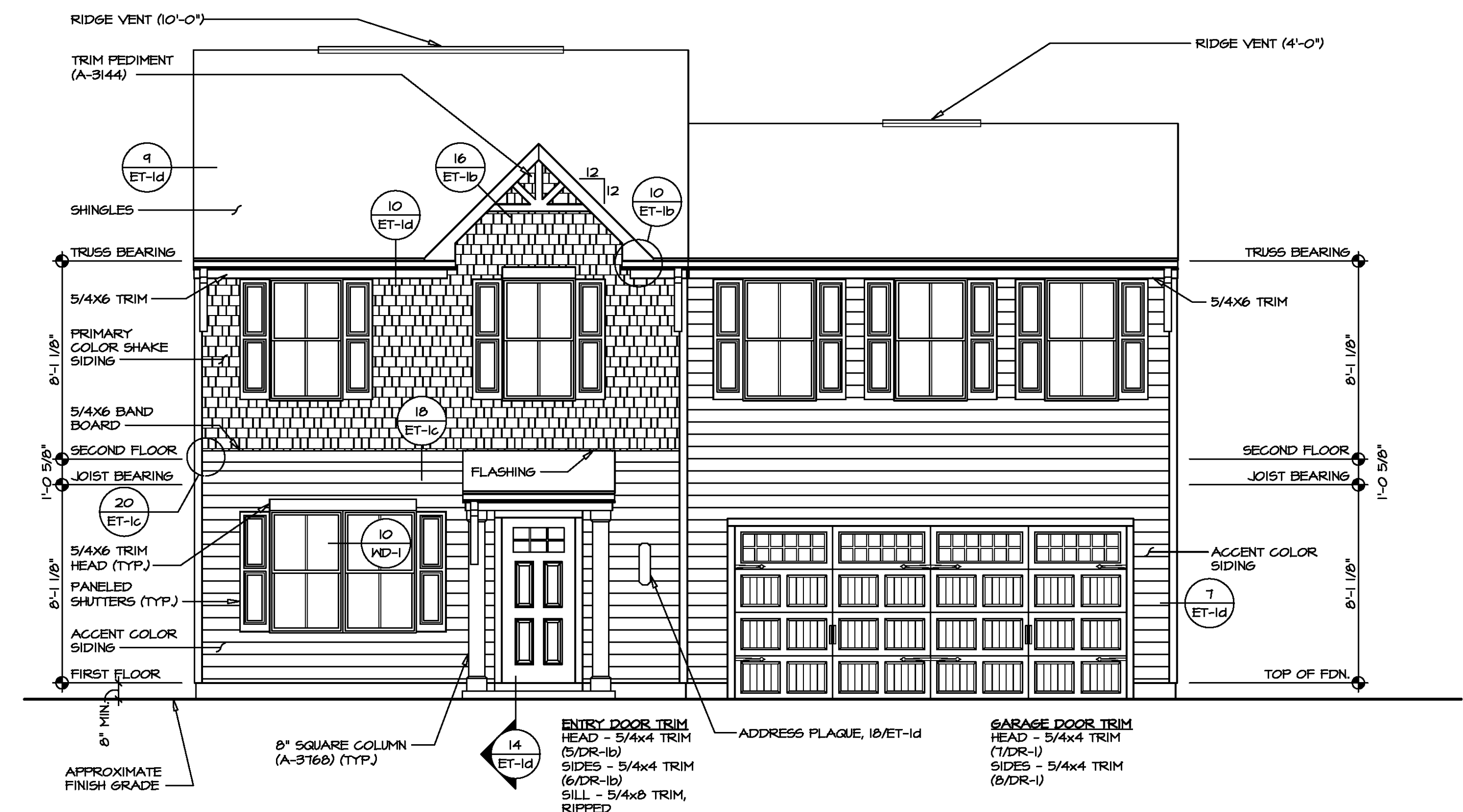
1 FRONT ELEVATION "K" A-1 SCALE: 1/4" = 1'-0"
