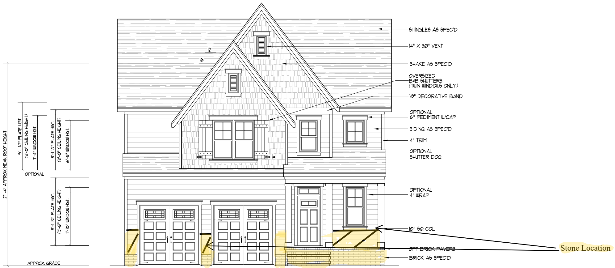
FRONT ELEVATION "A" SCALE: -----1/8" = 1'-0" HARDI FRONT
