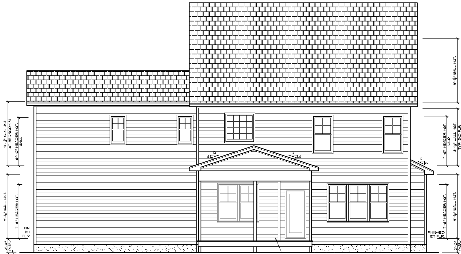
REAR ELEVATION - CLASSIC 22X34 PRINTS SCALE: 1/4"=1'-0" 11X17 PRINTS SCALE: 1/8"=1'-0"
