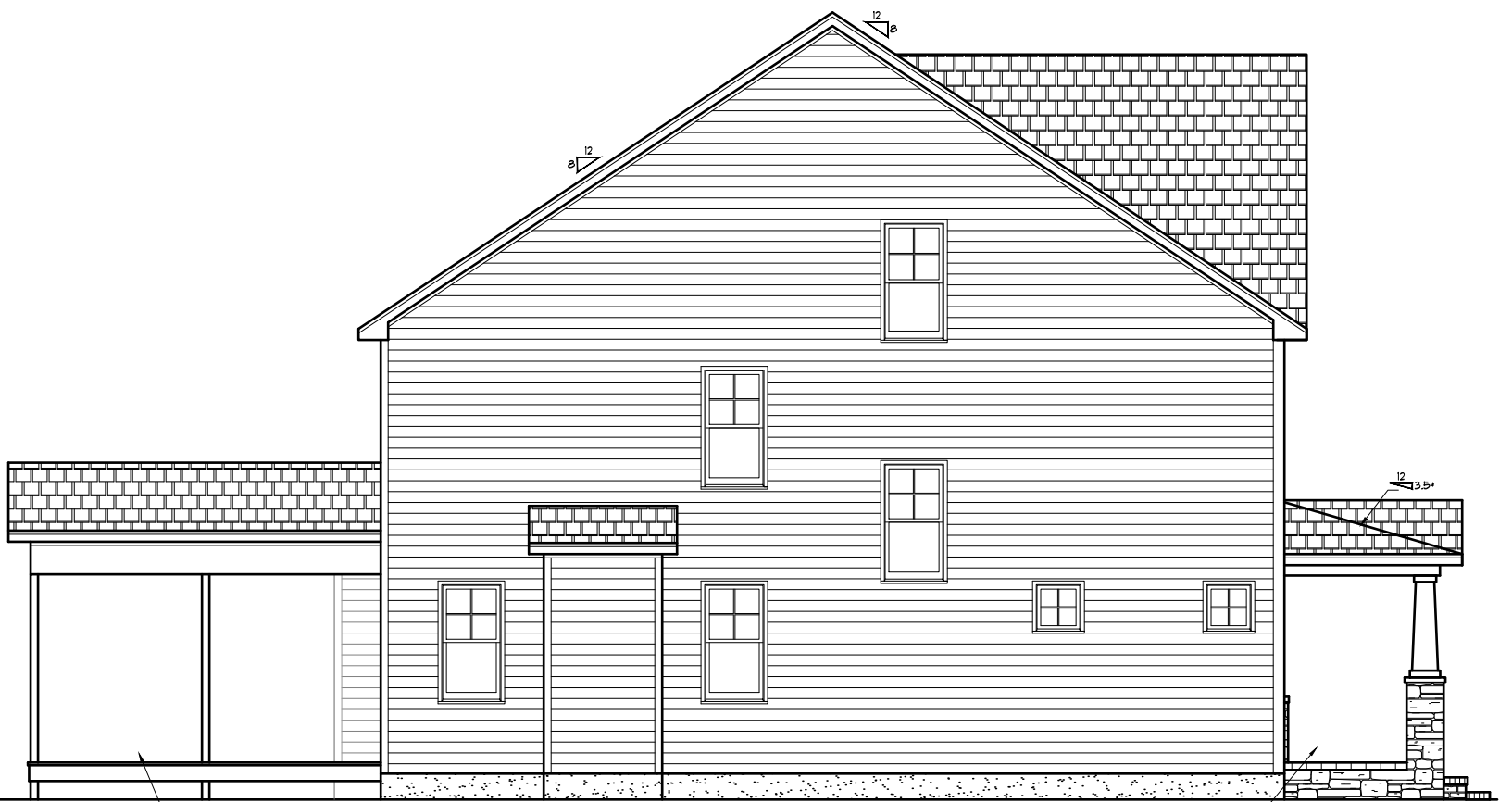
LEFT ELEVATION 22X34 PRINTS SCALE: 1/4"=1'-0" 11X17 PRINTS SCALE: 1/8"=1'-0"
