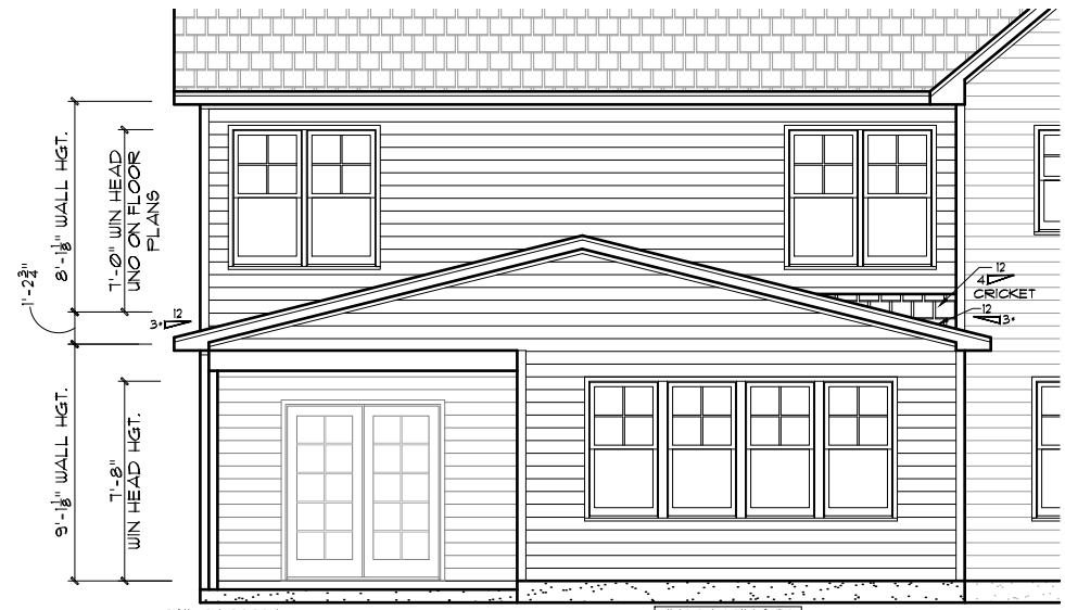
REAR ELEVATION 22x34 PRINTS SCALE: 1/4"=1'-0" 11x17 PRINTS SCALE: 1/8"=1'-0"
