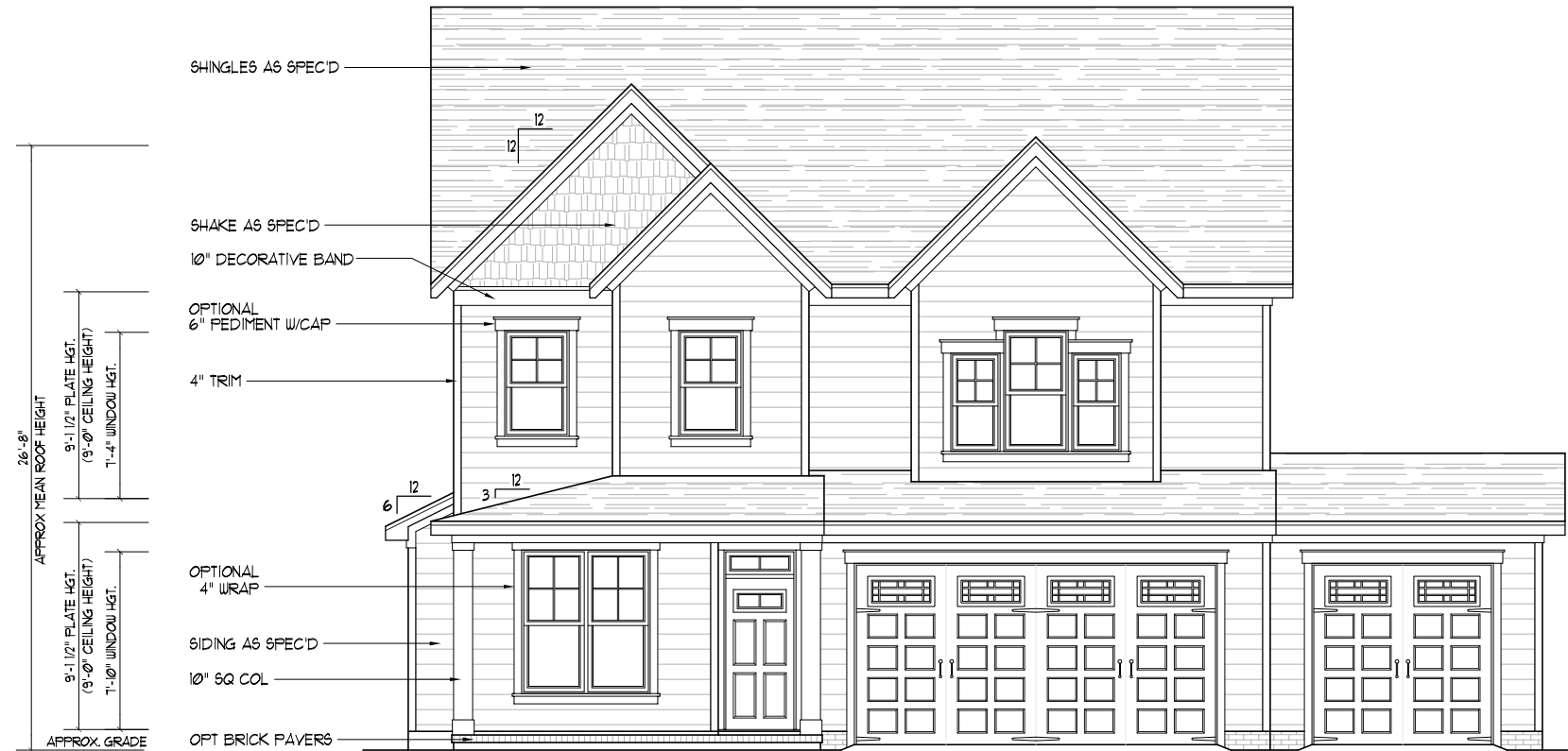
FRONT ELEVATION SCALE: 1/8" = 1'-0"
