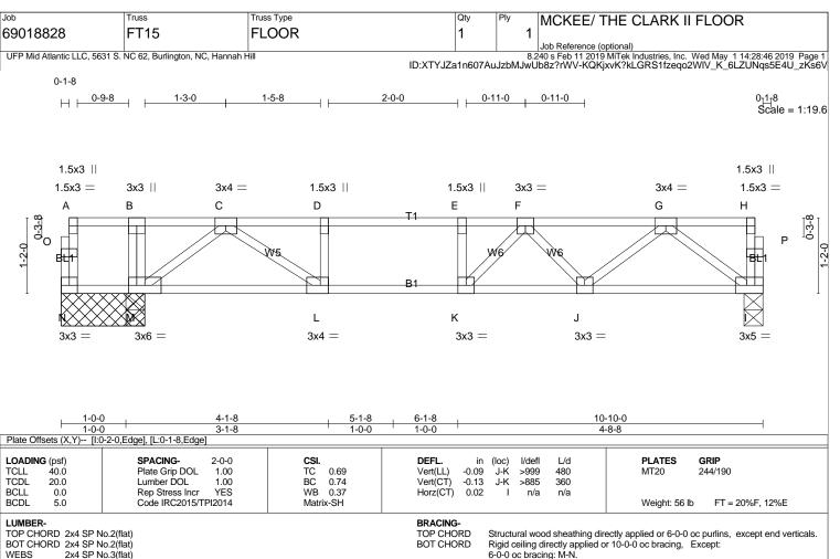
REACTIONS. (lb/size) N=43/1-3-8 (min. 0-1-8), I=611/0-3-8 (min. 0-1-8), M=707/1-3-8 (min. 0-1-8)
