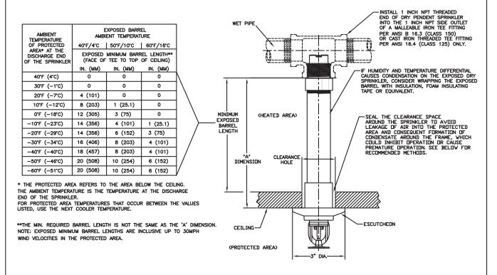
\*RECOMMENDED EXPOSED MINIMUM BARREL LENGTHS ALSO APPLY TO HORIZONTAL SIDEWALL DRY SPRINKLERS\*
