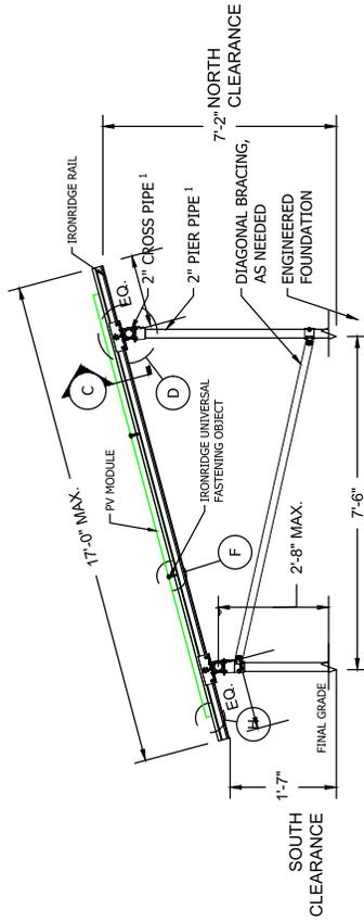
B 3-UP - PV SYSTEM SIDE SECTION
