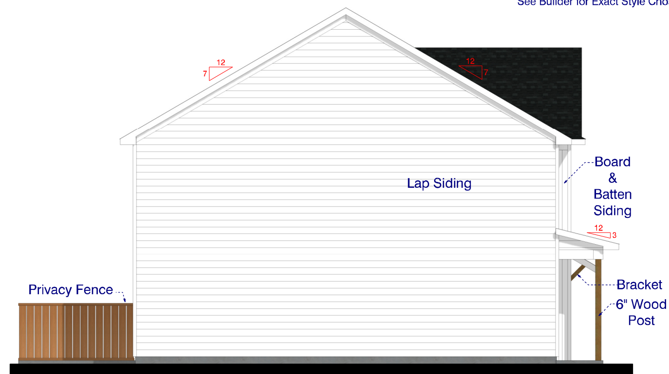
Left Elevation Scale: 1/8" = 1'0"
