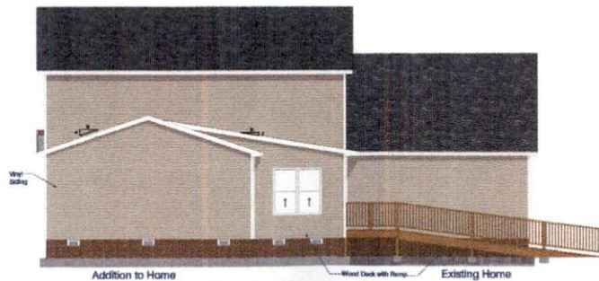
Rear Elevation Scale: 1/8" = 1'0"
