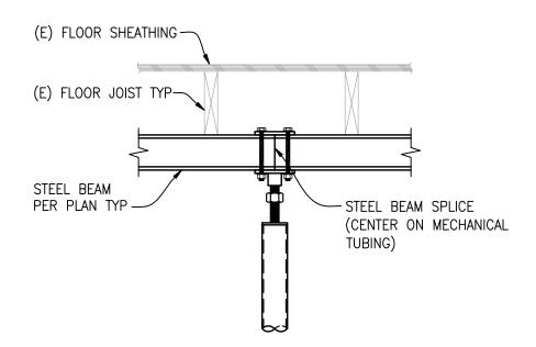
STEEL BEAM SPLICE CONDITION
