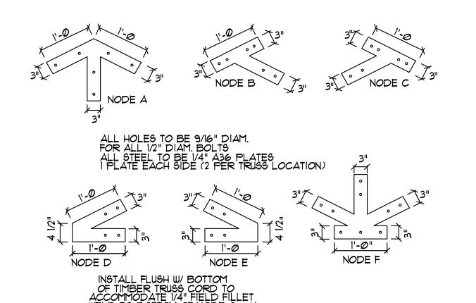
ROOF TRUSS SCALE: NTS
