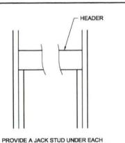
**ENDWALL HEADER FOR** OPENINGS UP TO 9'-0". SIDEWALL HEADER FOR OPENINGS UP TO 4'-0".
