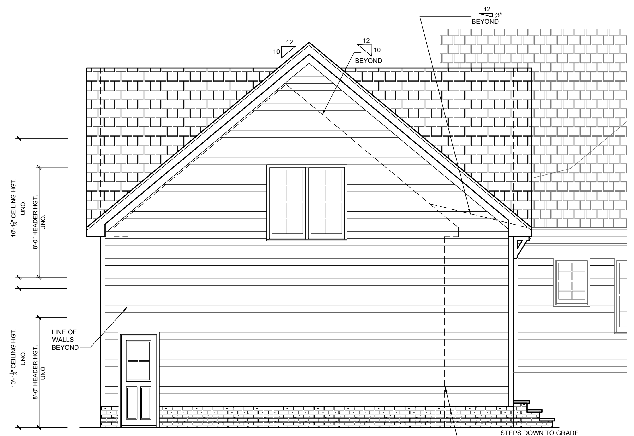
LEFT ELEVATION 22X34 PRINTS SCALE: 1/4"=1'-0" 11x17 PRINTS SCALE: 1/8"=1'-0"
