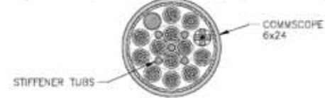
(6x24) HYBRID TRUNK CROSS SECTION 8.5" x 11" SCALE N.T.S. | 11" x 17" SCALE N.T.S. 1
