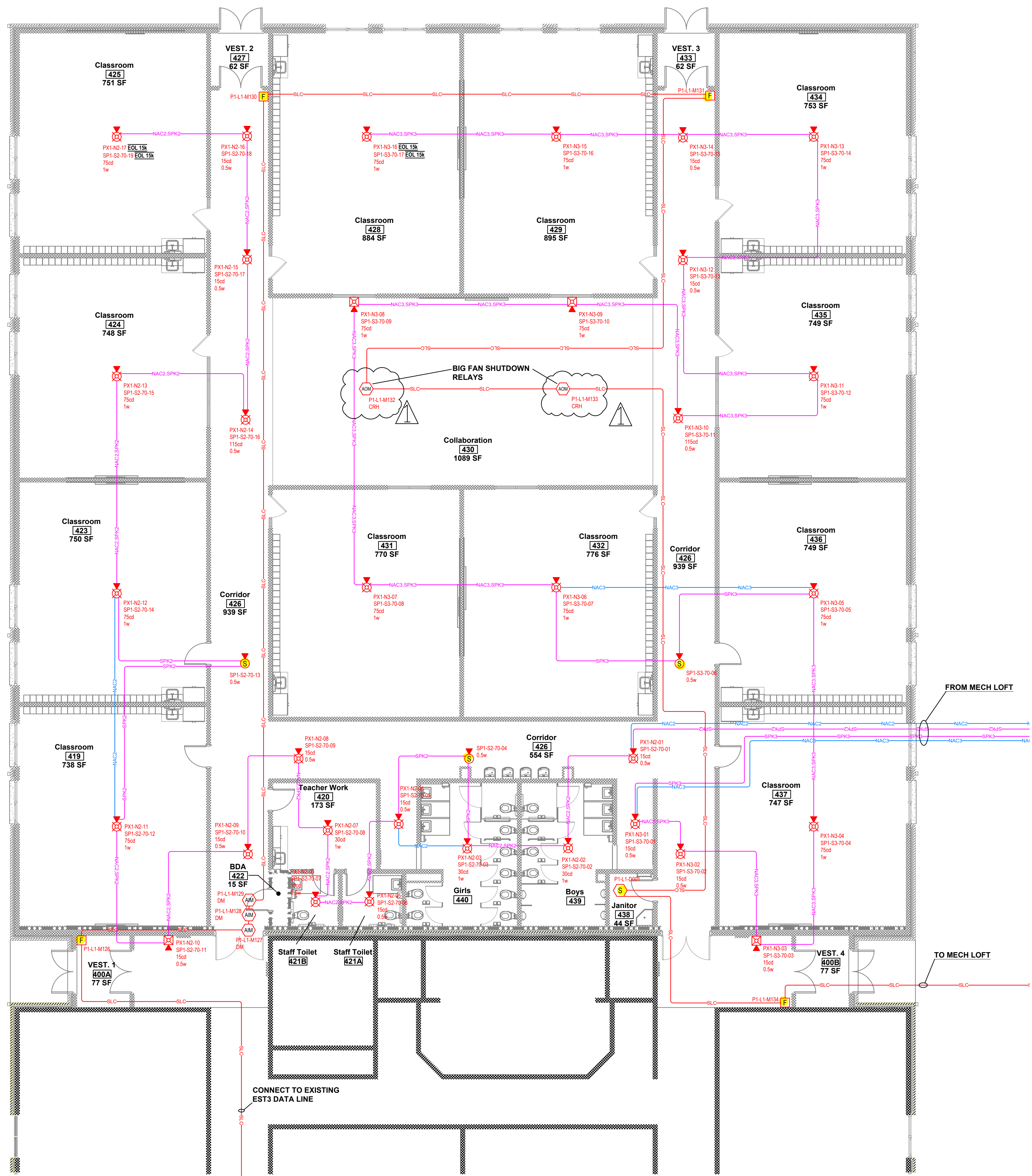
1 FIRST FLOOR FIRE ALARM SCALE: 1/8" = 1'0"
