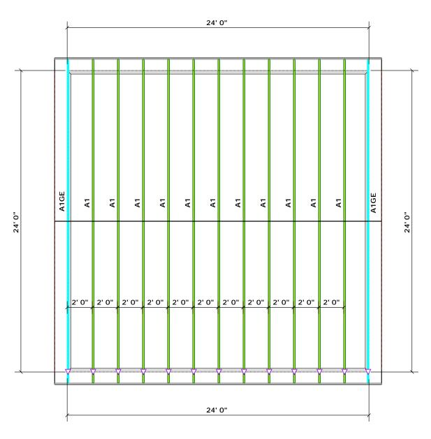
TRUSS PLACEMENT PLAN
